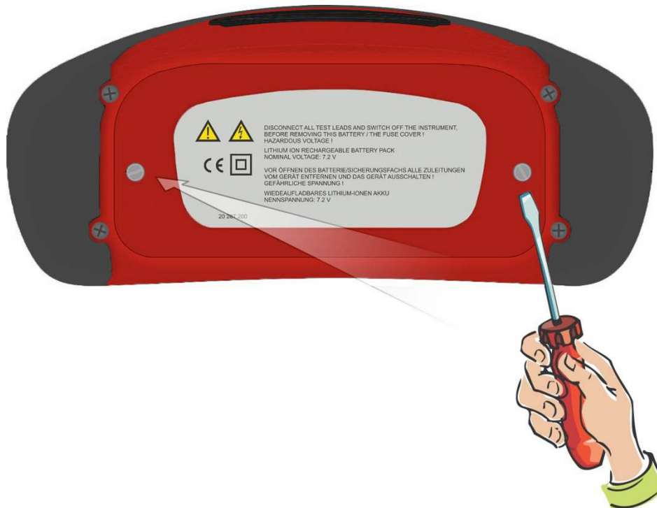
Abbildung 7.1: Position der beiden Schrauben zum Öffnen des Batterie- und Sicherungsfachs
