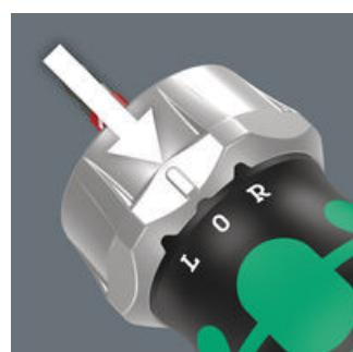
Die Ratschenmechanik ist feinverzahnt für einen geringen Rückholwinkel. Über den Umschaltring kann die Schraubrichtung rechts/fest/links vorgenommen werden. Die magnetische Bitaufnahme ist für Bits mit 1/4"-Außensechskant antrieb nach DIN ISO 1173-C 6,3 und Wera Anschluss-Reihe 1 geeignet.
