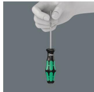
Das TORX® Profil mit dem Wera HF Feature (HF = Haltefunktion) hält durch eine optimierte Abtriebsgeometrie und die dadurch entstehende Klemmkraft TORX® Schrauben sicher auf der Werkzeugspitze. Ideal bei Arbeiten an schwer zugänglichen Stellen wie z. B. tiefliegenden Sacklochverbindungen.
