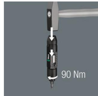
Jede noch so festsitzende Schraube muss gelöst werden können. Schlagschraubendreher sind die Lösung für den Fall, dass die manuelle Kraft nicht ausreicht und kein Druckluftschrauber zur Verfügung steht. Die Wera Schlagdrehgeräte haben einen besonders hohen Wirkungsgrad durch ihre robuste Doppelkurvenkonstruktion. Schlagende Kraft wird in eine Drehbewegung umgesetzt. Erspart den Einsatz von Druckluftgeräten.
