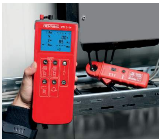
DC-Betriebsstrommessung mit BENNING CC 3
